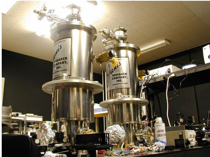
図 4: 高量子効率光子検出システム
